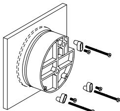
Perfore un círculo de 115 mm de diá. en el panel, y sostenga el instrumento mediante los. Para montaje sobre caño, ordene el adaptador A-610 apto para caños de 32 a 50 mm de diá.
