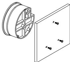
Perfore tres orificios separados 120° sobre una circunferencia de 105 mm de diá. y sostenga el instrumento con tres tornillos 6-32 de long. apropiada.
